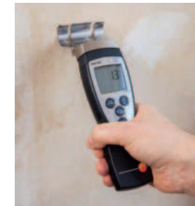
Feuchtigkeitsprüfung Ermitteln des Feuchtigkeitswertes mit Hilfe eines Hygrometers
